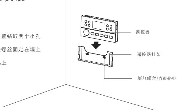
※ 注：膨胀螺丝的大小，以及钻头的尺寸，以实物测量为主。
