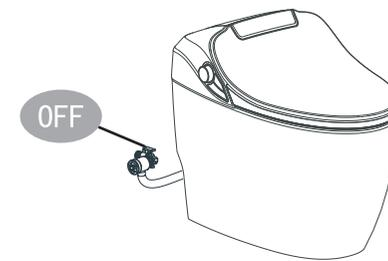
3. 从进水阀门上卸下进水软管，排尽软管中的水。
